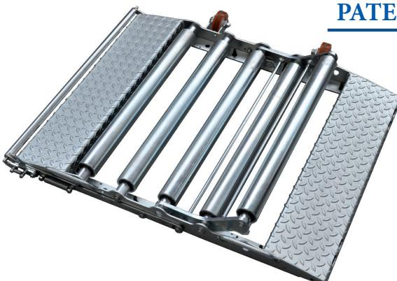
Il kit si compone di 2 rulliere da collocare sotto l'asse non in prova. La particolare struttura delle rulliere che alloggiano l'asse del veicolo, impedisce l'arretramento in fase di frenata, consente la misura inalterata della efficienza frenante. Revisione dei sistemi frenanti 4WD con esiti certi, automaticamente acquisiti dal sistema MCTCNet2, in tempi certi, gli stessi dei veicoli 2WD.
