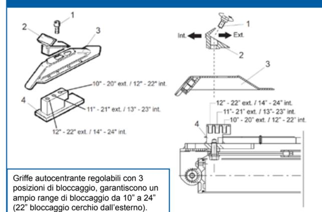
Griffe autocentrante regolabili con 3 posizioni di bloccaggio, garantiscono un ampio range di bloccaggio da 10" a 24" (22" bloccaggio cerchio dall'esterno).
